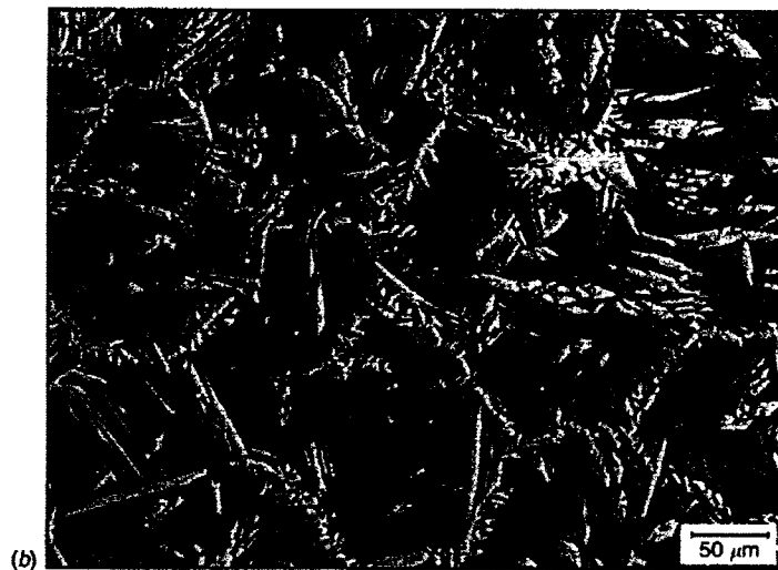
شکل ۶۵: ریزساختار فلز جوش فولادهای زنگ نزن دوفازی (a) میزان فریت بالا (FN = ۱۰۰) (b) میزان فریت متوسط (FN = ۷۰) [۳].
